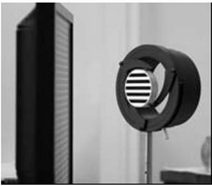
图 4 标准球面反射镜面形测量
